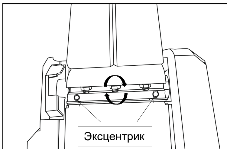
Рис.3. Замена режущего ножа
